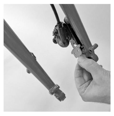
**REMOVE THE BRAKE PAD SPACER**
